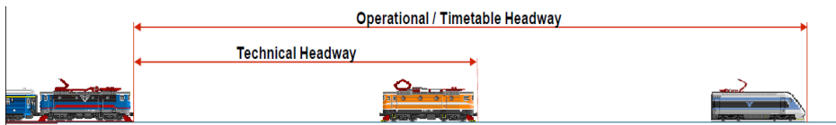
Figur 7 Illustration av teknisk och praktisk headway. Källa: KTH
