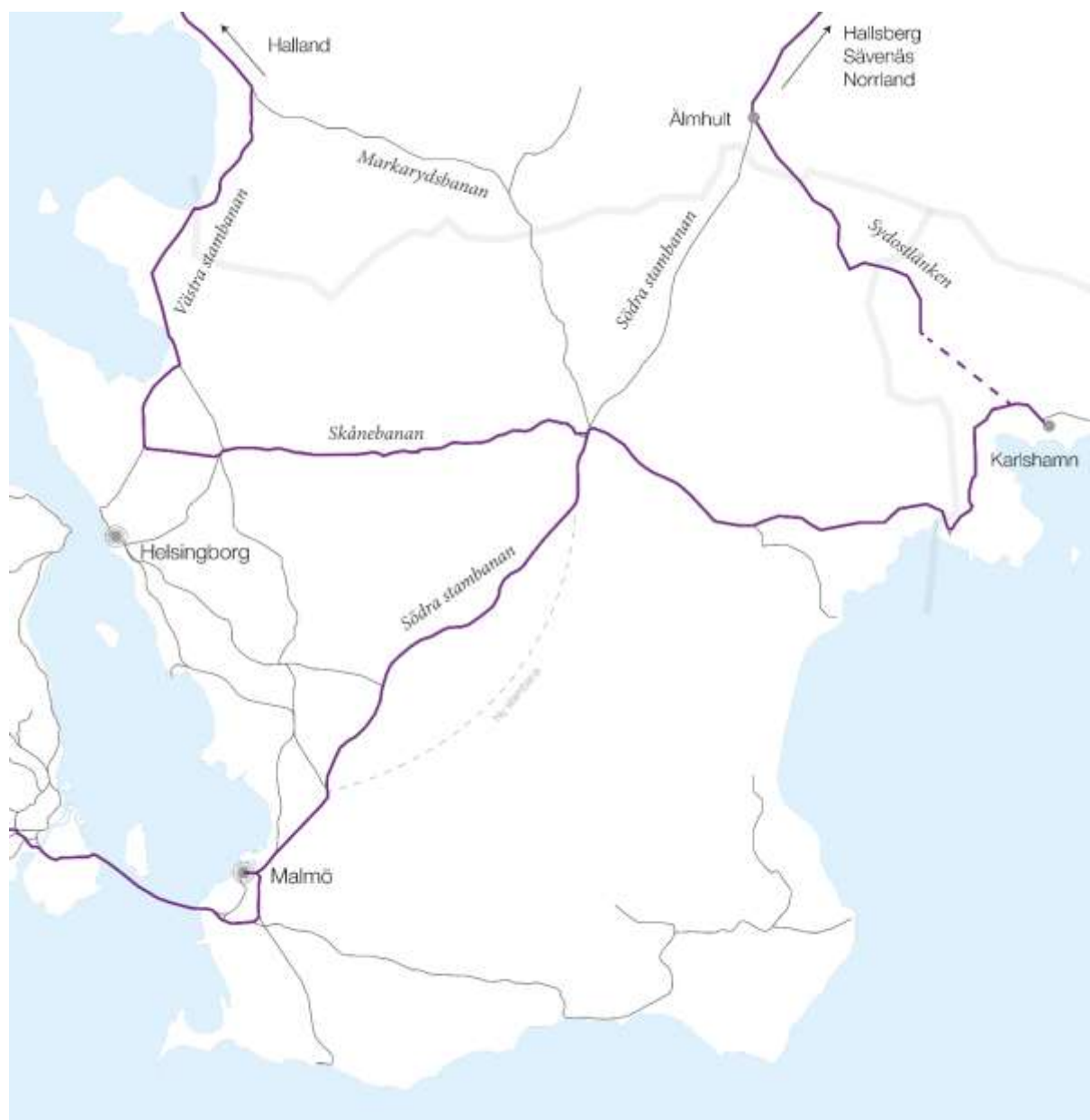
Figur 18: Godstrafik på järnväg till/från Blekinge med Sydostlänken byggd. Det behövs även ett triangelspår vid Almhult, anslutning mellan Södra stambanan och Sydostlänken. Den streckade delen av Sydostlänken är helt järnväg i ny sträckning, övriga delar (Älmhult-Olofstrom) elektrifieras och rustas upp.
