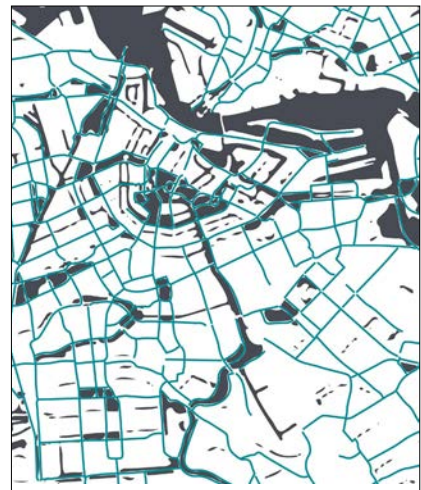
Cykelvänligheten beror både på hur sammanhängande ett cykelnätet är, hur gena stråken är och vilken maskvidd nätet har. Översta bilden visar centrala delarna av Stockholms cykelnät och understa bilden visar centrala delarna av Amsterdams cykelnät. Kartorna är i samma skala.
