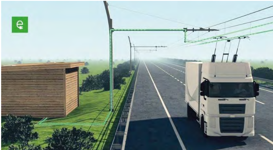
Figur 45. Exempel på konduktiv överföring ovan väg med pantograf på fordonet (TRL)
